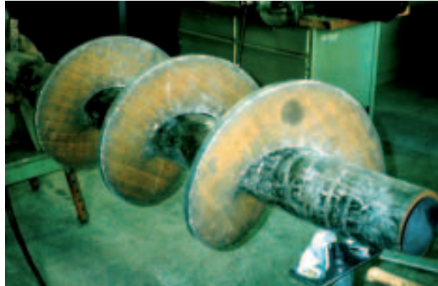
Bild 7: Schneckenförderer, durch Auftragschweißen verschleißtechnisch in die Tieflage versetzt
