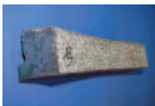
Bild 12: Abstreifer aus Kompositlegierungen Fig. 12: Composite-alloy scraper
